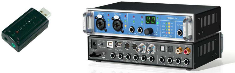
*Grafik A.4 Beispiele für Audio-Interfaces, einfach und hochwertig. Links eine einfaches USB-Interface mit 'Consumer'-Anschluß für ca. 10 Euro. Rechts ein professionelles Audio-Interface höchster Qualität (oben Vorder-, unten Rückseite), das etwa das 100-fache kostet. (Bildquelle rechts: RME)*
