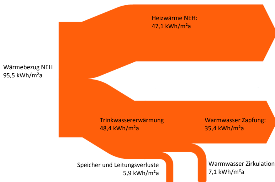
Bild 21 Energieflussbild des NEH. Auffällig ist der hohe spezifische Wärmeverbrauch der Trinkwassererwärmung. Der Wärmeverbrauch zur Trinkwassererwärmung ist größer als der Heizwärmeverbrauch. Die angegebenen Daten sind nicht witterungsbereinigt – die Angaben für den Heizwärmeverbrauch weichen deshalb von den in Tab. 5 genannten Werten ab. Speicher- und Leitungsverluste der Trinkwassererwärmung wurden aus der Bilanzierung der Warmwasserspeicher errechnet.
