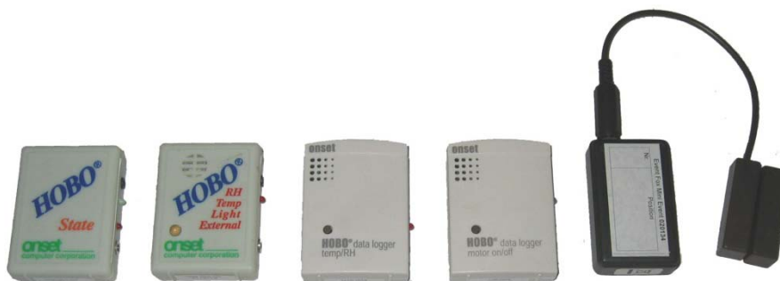
Bild 14 Eingesetzte Miniatur-Datenlogger. Mit Hilfe der streichholzsachtelgroßen Geräte konnten dezentral Lufttemperatur und Luftfeuchte, sowie Motorlaufzeiten und Fensteröffnungen über einen begrenzten Zeitraum gemessen und ausgewertet werden.
