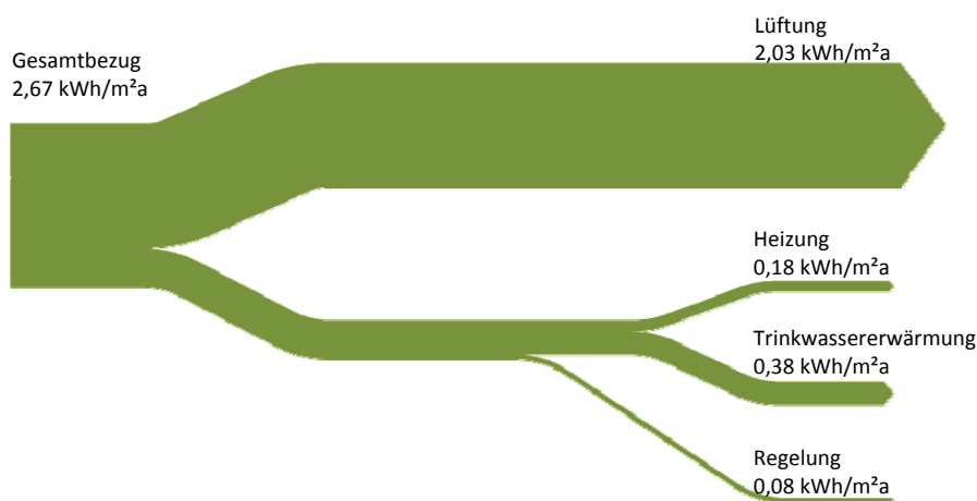
Bild 23 Energieflussbild des Stromverbrauchs für Hilfsstrom. Wenngleich im NEH nur bedarfsgeführte Abluftventilatoren installiert sind, dominiert dennoch die Lüftung den Stromverbrauch für die TGA. Der Stromverbrauch der Lüfter wurde aus Messungen der Lüfternutzungs- und Laufzeiten hochgerechnet (siehe ‚5.2.1.1 Nutzung der Bedarfslüftung‘).
